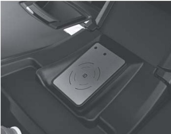
Vielfältige Zugangskontrollmöglichkeiten: optionaler Zugang mittels FleetManager oder PIN-Code, sowie serienmäßiger Zugang über Schlüsselschalter
