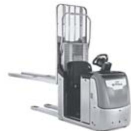
Der OPX-L 16 vereint die Fähigkeit, mit einem minimalen Wenderadius zwei Paletten gleichzeitig zu transportieren. Ideale Voraussetzungen, um den vorhandenen Lagerplatz voll auszunutzen und die gelagerten Waren besonders effizient zu kommissionieren. In Verbindung mit dem innovativen STILL EASY Drive Lenkrad spielen Sie die Stärke seiner präzisen Wendigkeit voll aus und manövrieren auch zwei voll beladene
