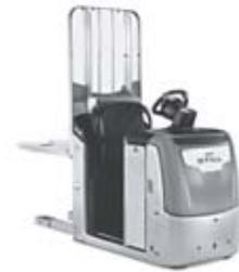
Kraft, Ergonomie und Wendigkeit sind die Markenzeichen des OPX-L 12: Dank seinem Mast heben Sie die zu kommissionierenden Waren mit einem Gesamtgewicht von bis zu 1.200 kg auf eine optimale Arbeitshöhe von bis zu 786 mm – rückschonende Ergonomie in Serie. Noch mehr Komfort verspricht die optionale Autolift-Funktion: Das Fahrzeug hebt und senkt die Palette je nach Beladezustand
