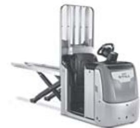
Der OPX-L 20 S hebt die Arbeitsmoral – Scherenhub sei Dank stellen Sie je nach Körpergröße und Beladungszustand ganz leicht die ergonomisch optimale Arbeitshöhe von bis zu 785 mm ein. Rückschonendes Arbeiten ist nur eine Facette des smarten Kommissionierfahrzeugs: Mit einer Gabellänge von 2.390 mm hebt der OPX-L 20 S gleich zwei Europaletten gleichzeitig. Dabei ist er stark
