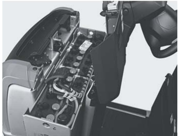
Optional seitlicher Batteriewechsel garantiert höchste Verfügbarkeit und beste Ergonomie für den Anwender
