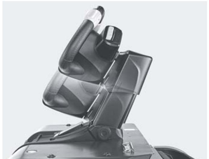
Höchste Ergonomie aufgrund des verstellbaren Lenkrads in der Höhe und mit leichtem Winkel für individuelle Bedienvorlieben
