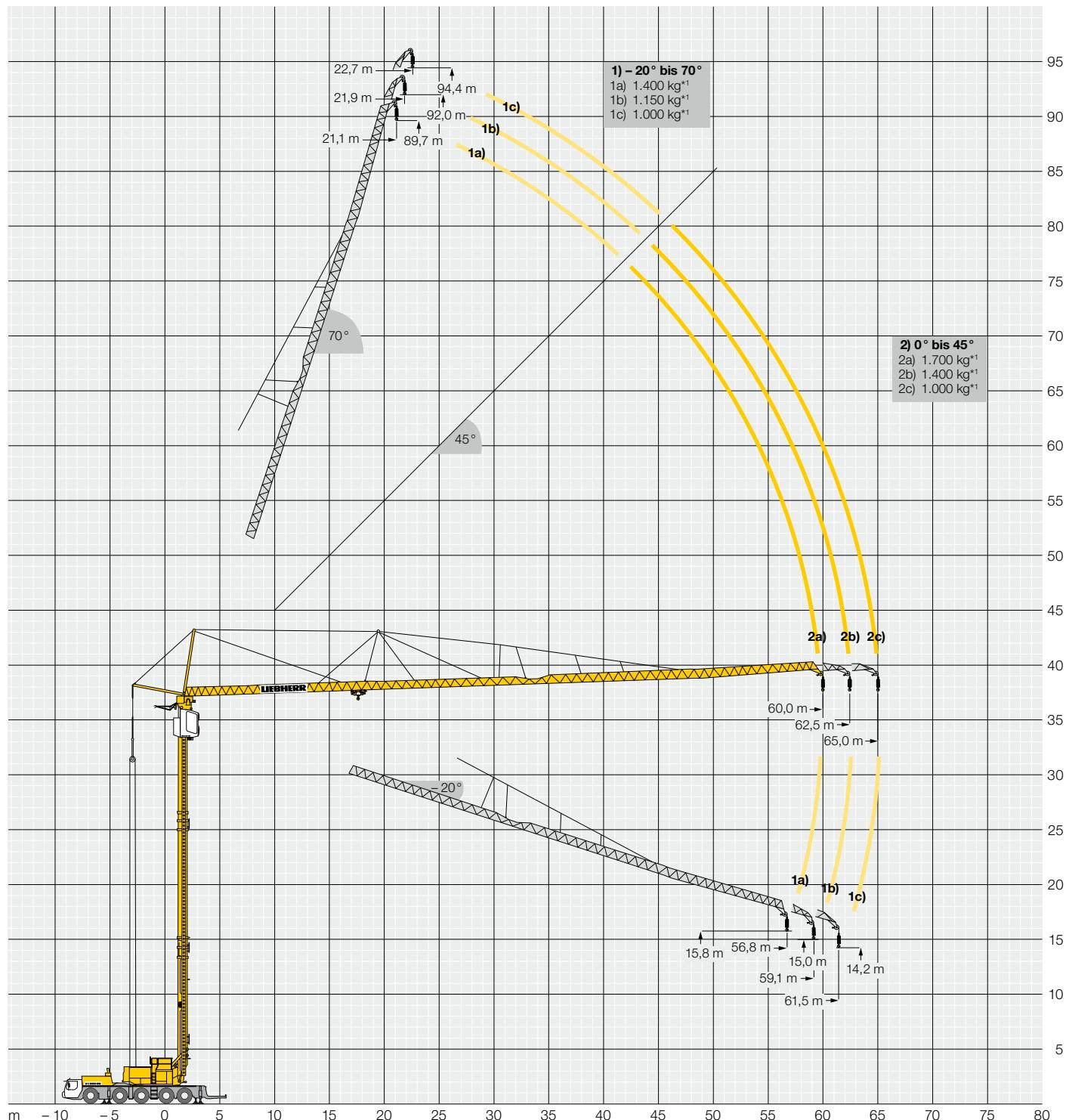
**\*1 Traglasten mit 9,0 t Zusatzballast**/Load capacities with 9.0 t additional ballast/Charges avec lest additionnel 9,0 t/Cargas con 9,0 t de lastre adicional/
