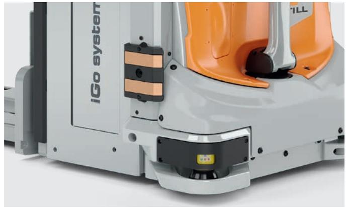
Der gesamte Ladeprozess des EXV iGo systems kann vollautomatisiert realisiert werden: Ladkontakte sowohl für Lithium-Ionen- als auch für Blei-Säure-Batterien
